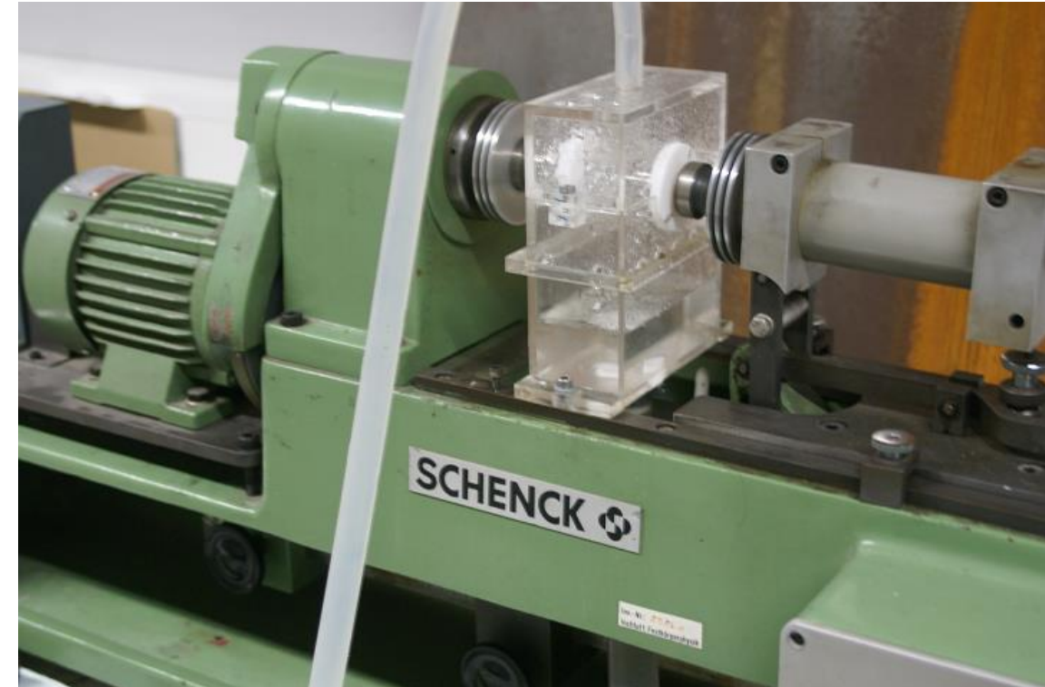
Umlaufbiegeprüfstand mit Korrosionsbehälter für Sprühversuche
