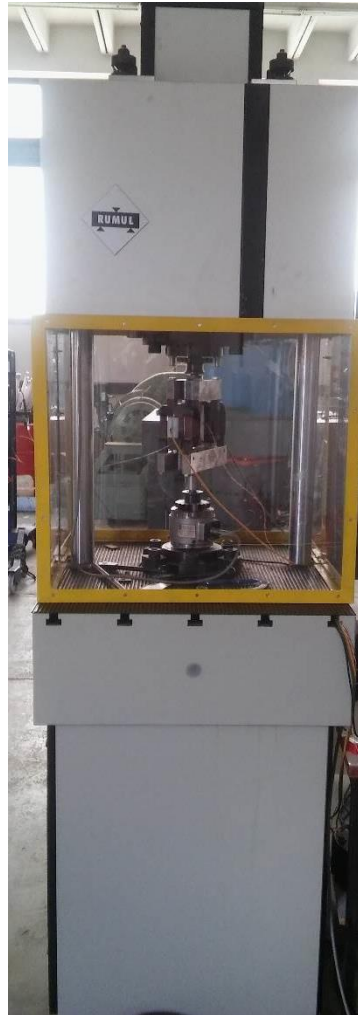
Resonanzprüfmaschine (RUMUL TESTRONIC)
