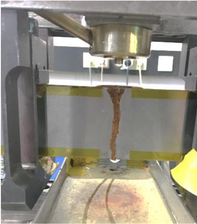
8-Punkt Biegevorrichtung mit Tropfvorrichtung (SEB-Probe)
