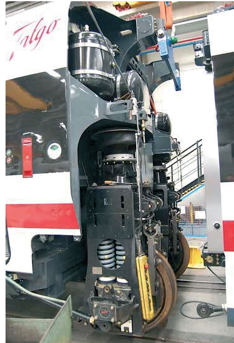
Rolling gear of the new Talgo AVRIL
