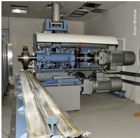
Linearprüfstand in Mödling konfiguriert für Versuche mit Sandapplikation
