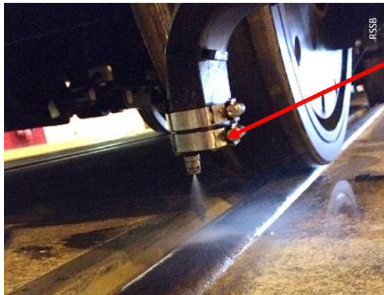
Versuchskonfiguration der Class 387 Versuchszüge der RSSB-Sandungsversuche gem. RSSB-Bericht T1107
