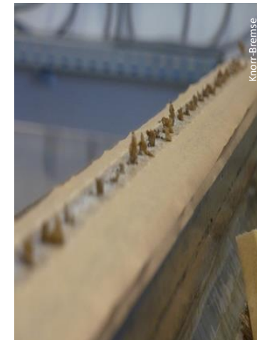
Beispiel einer Präparation der Versuchsschiene
