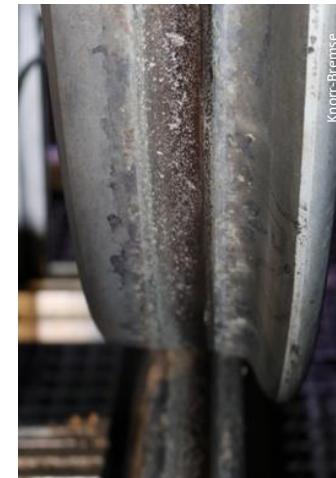
Laub kontaminiertes ATLAS-Rad/Schienenrad
