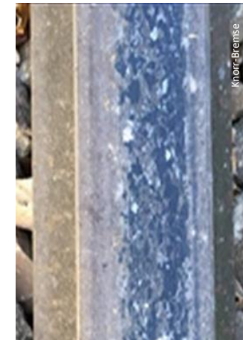
Laub kontaminierte reale Schiene
