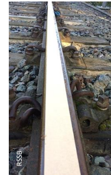
Neu mit Papier präparierte Schiene
