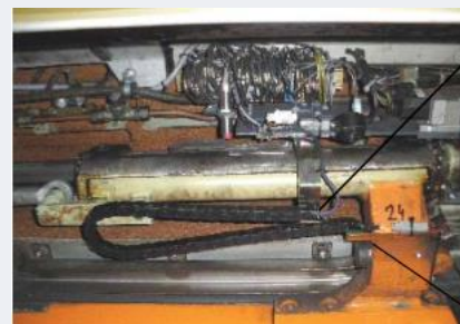
Abb 4 Aufbau der Energiekette
