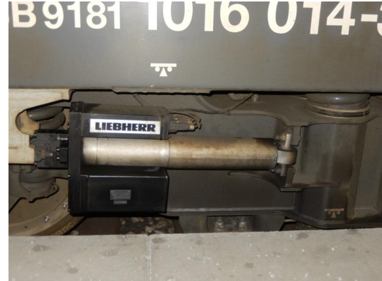
aktiver Drehdämpfer / ADD (Fa. Liebherr)
