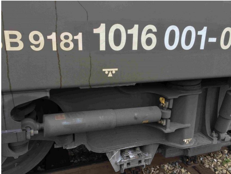
Frequenzselektiver Drehdämpfer (Fa. KONI)
