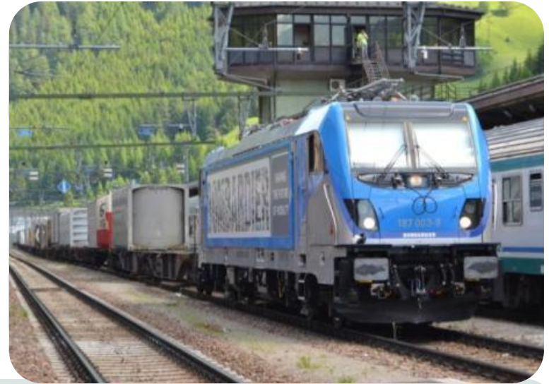
TRAXX AC: 4-achsen Elektro Lokomotive Mit 5600kW am Rad , mit Last Mile bestehend aus Traktionsbatterie und Dieselmotor
