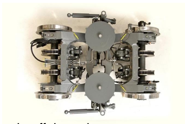
Lauffahrwerk Achssstand 2100 mm
