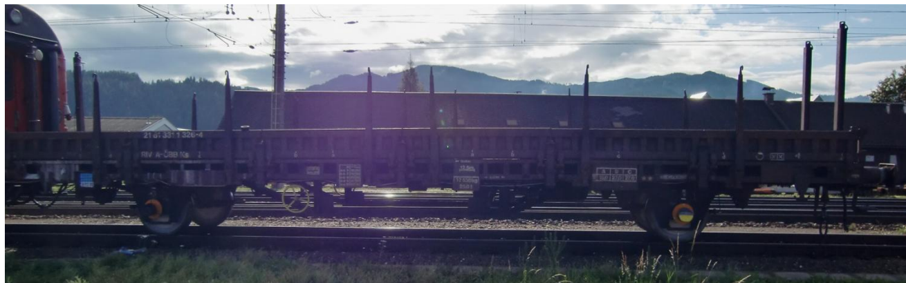
Erprobungsträger – zweiachsiger Flachwagen mit freien Lenkachsen
