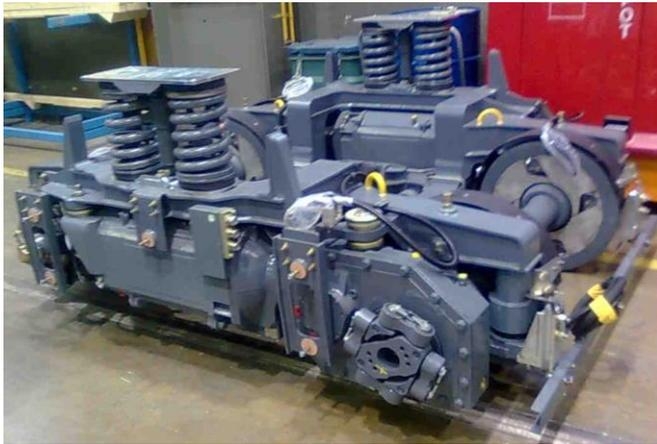
Triebfahrwerk Typ *Flexx Urban1000-MG*
