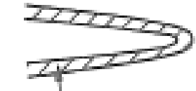
oxidinduziertes Riss schließen 1
