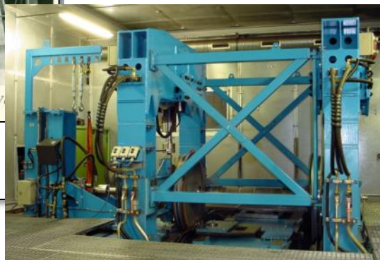
Bild 24: Radsatz-Rollprüfstand der Bundesbahn-V stalt Minden.
