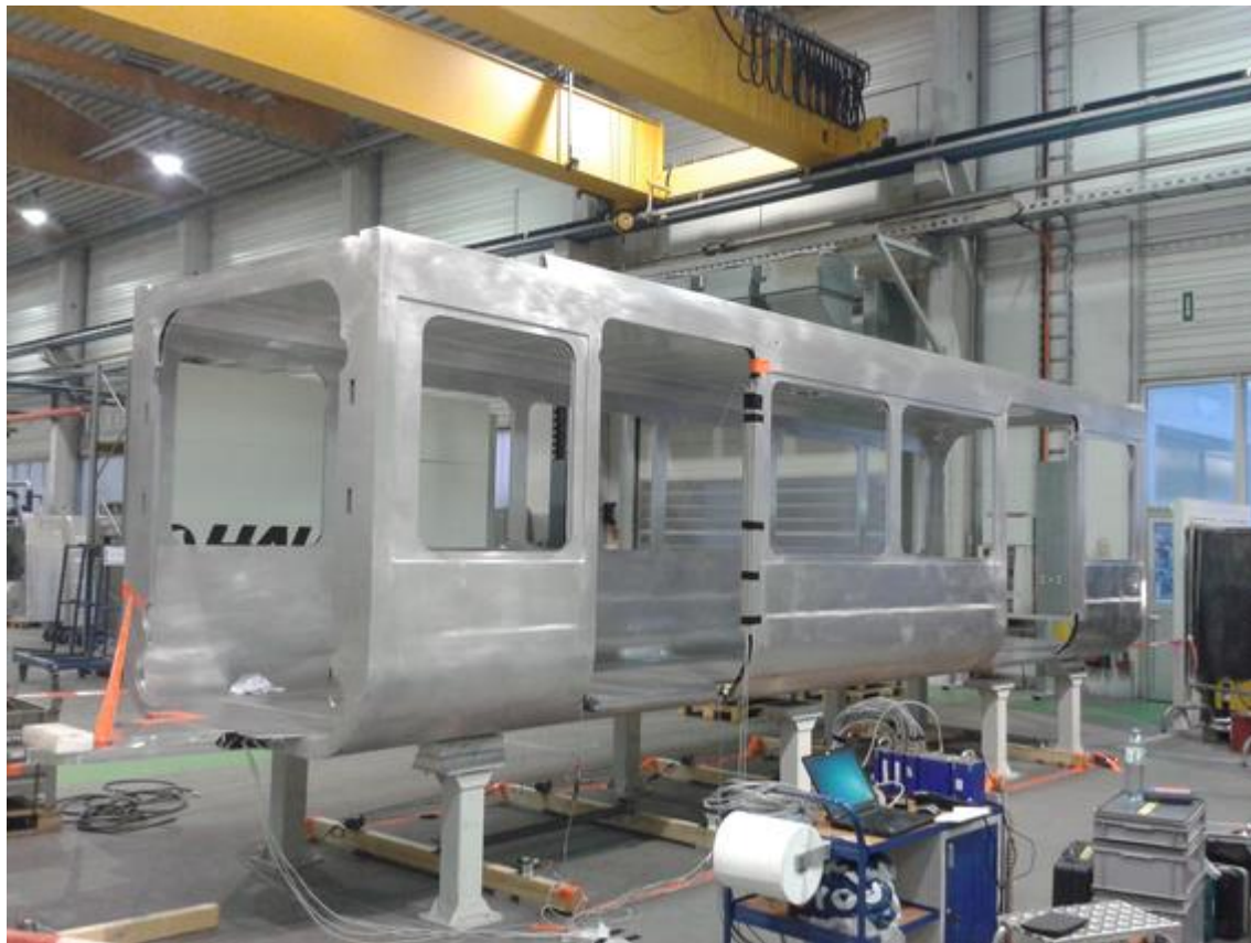
Messung der Wagenkastendurchbiegung
