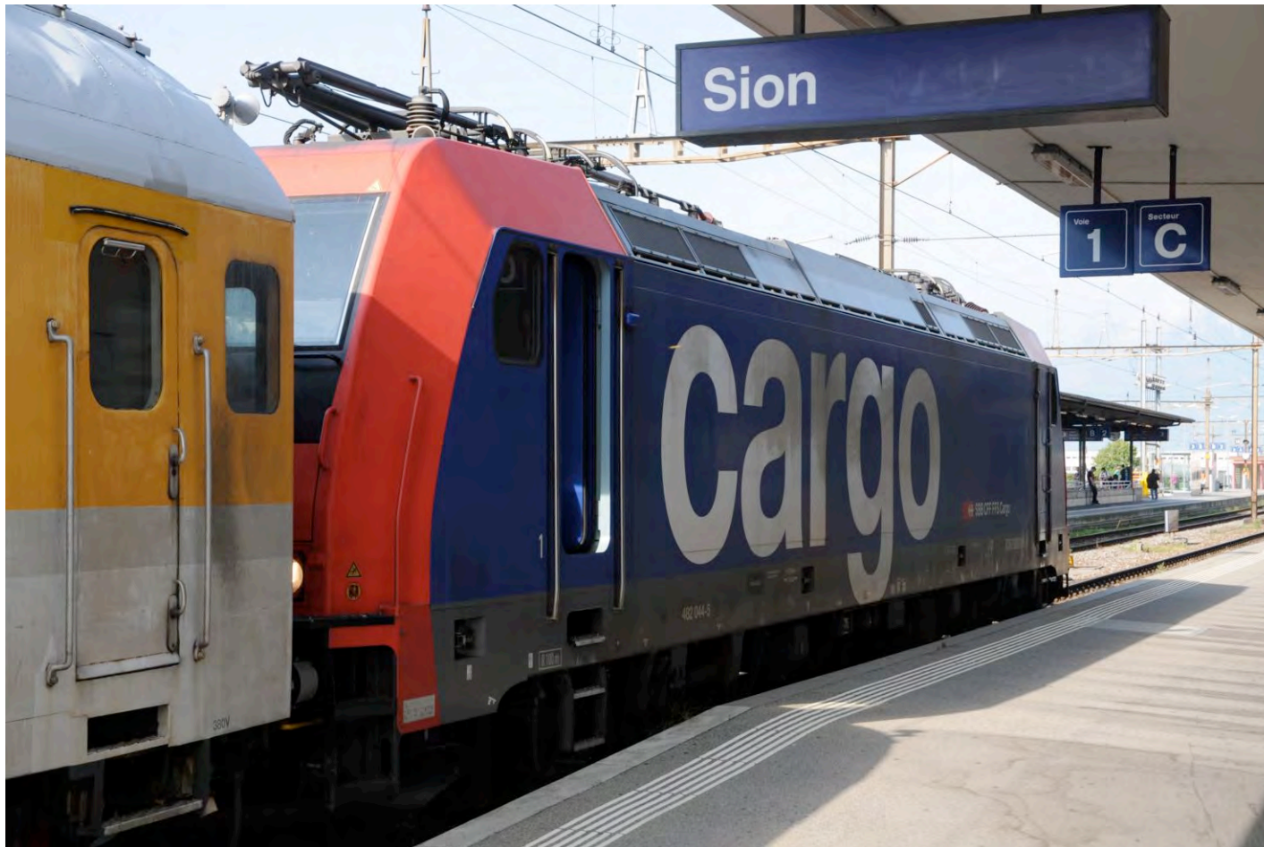
Re 482 von SBB Cargo und Messwagen der DB Systemtechnik (August 2014)
