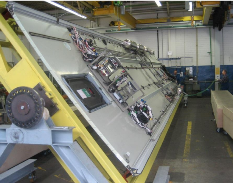
Ausrüstung modulares Sandwichdach in Montagelehre
