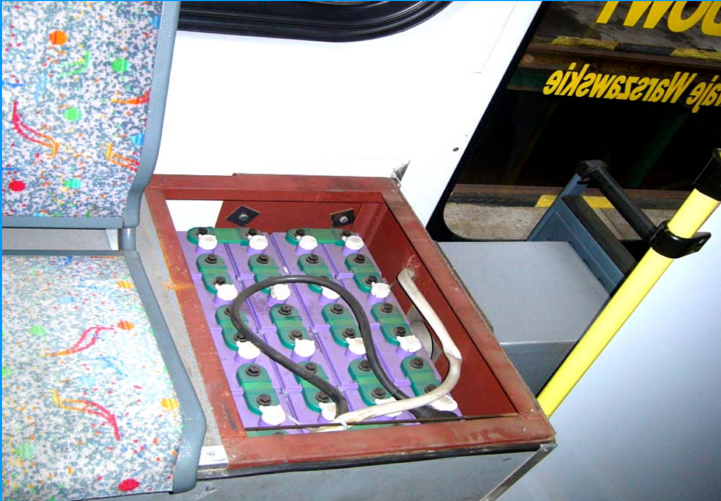
Unterbringung Zellen Akku-Satz in Tram 116N
