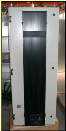
Elektronikpaket für Personenverkehr (ZMS, ZWS, FMZ, WTB) und deutsche Zugsicherung
