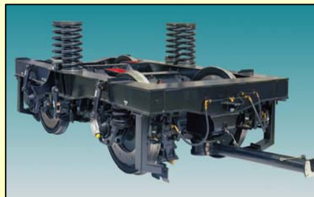
Drehgestell mit vollabgefedertem Hohlwellenantrieb
