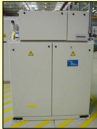
Stromrichter mit integriertem ZEV-Wechselrichter
