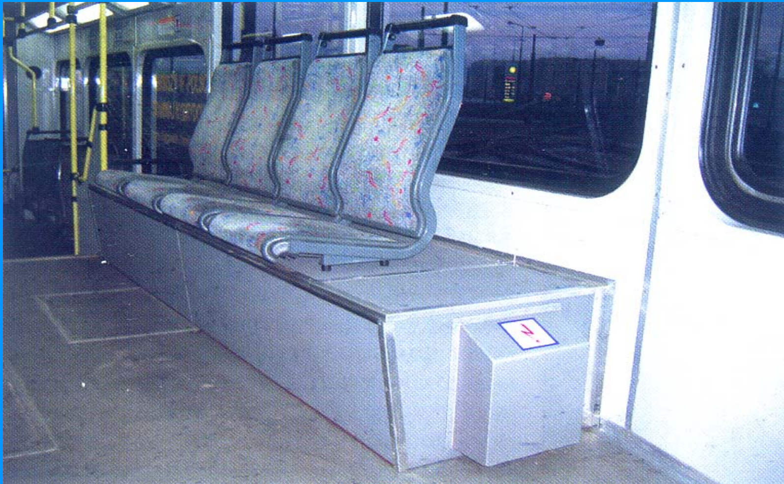
Unterbringung Zellen Akku-Satz in Tram 116N
